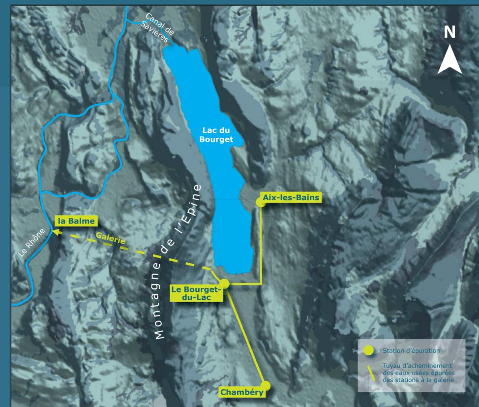
Vue en plan du tracé de la galerie et des conduites acheminant les eaux usées épurées sortant des stations d'épuration de Chambéry et d'Aix-les-Bains
